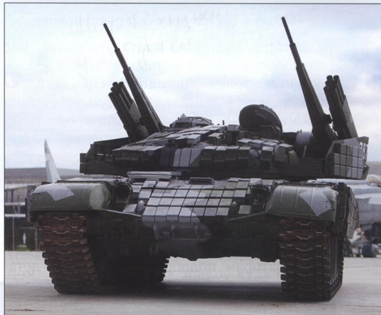
Большой угол возвышения 30-мм пушек позволяет поражать цели на горных кручах и на крышах высоких зданий
