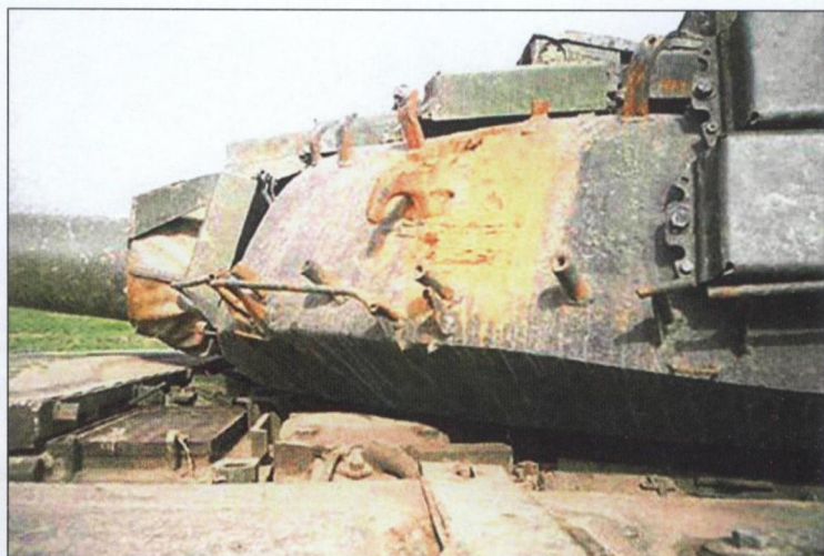
Результат попадания противотанковой ракеты в башню Т-72: часть блоков динамической защиты сорвало взрывом, но броню танка они защитили – остался только «ожог»
