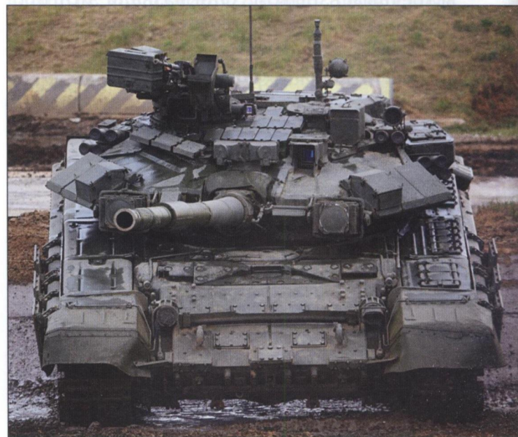
Современный российский танк Т-90. «Коробочки» динамической защиты первого поколения заменены панелями встроенной динамической защиты
