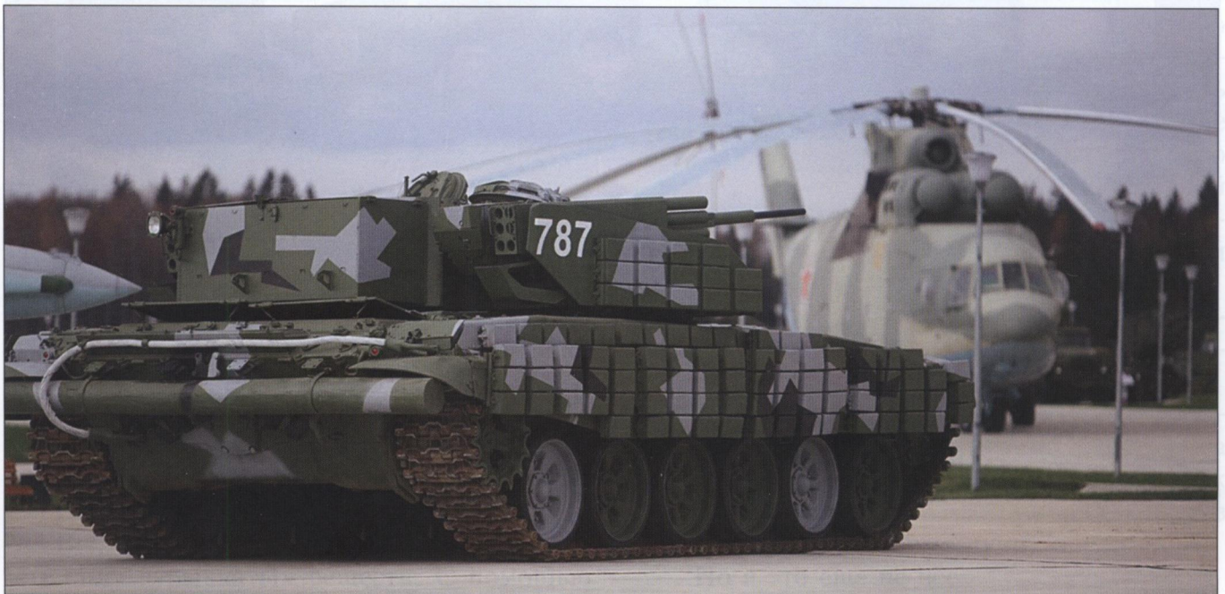
Большой угол возвышения 30-мм пушек позволяет поражать цели на горных кручах и на крышах высоких зданий
