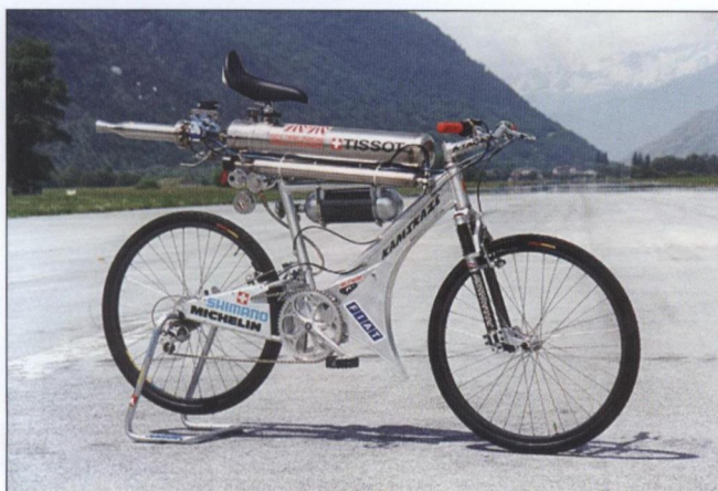
Велосипед с ракетным двигателем, на котором была достигнута скорость 285 км/ч
