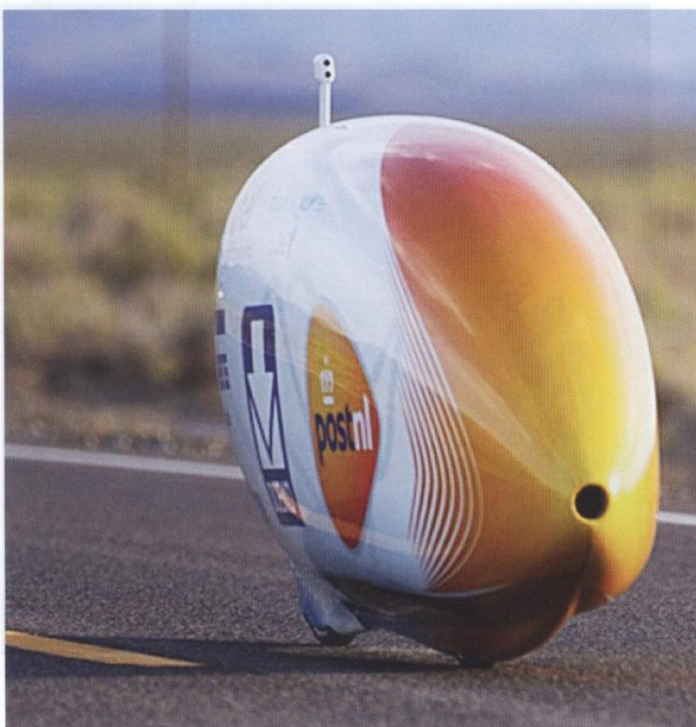
Этот обтекаемый велосипед студенты из Амстердама заставили ехать со скоростью 133 км/ч, и тот же аппарат со снятой половинкой обтекателя
