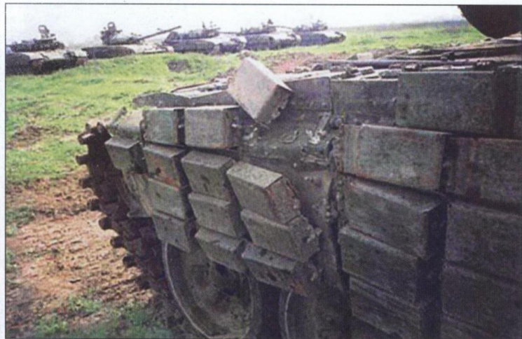
Результат попадания противотанковой гранаты в борт Т-72 – броня не пробита
