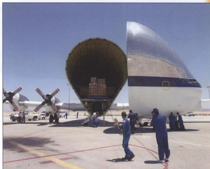
Погрузка в «Супер Гуппи» проводилась через откинутую носовую часть
