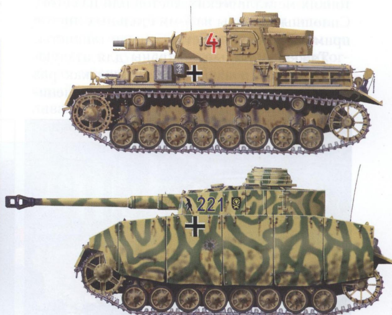
Вот так изменился внешний вид немецких танков после навески бортовых экранов
