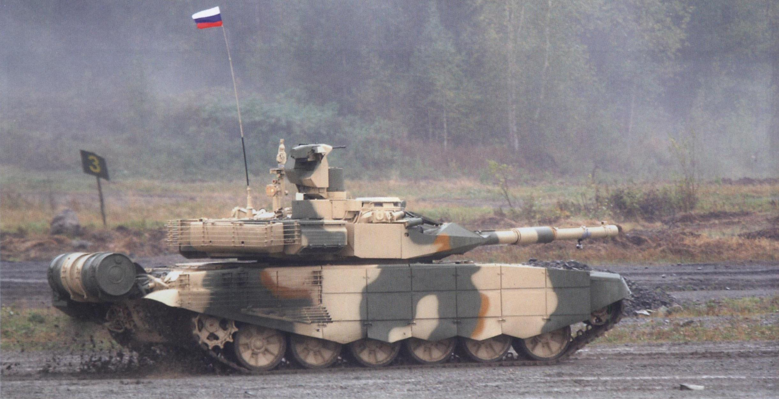
Опытный танк Т-90МС с новым комплексом динамической защиты и схема ее установки (Смотрите также рисунки на первой и четвертой страницах обложки)
