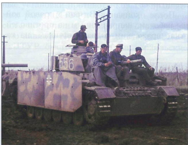
Первыми оснастили свои танки противокумулятивными экранами немцы. Так они пытались защититься от кумулятивных снарядов нашей артиллерии
